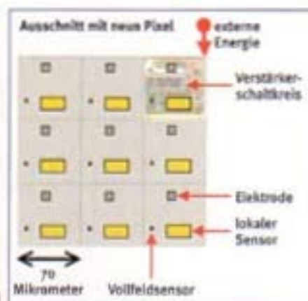
Der Sehchip des aktiven Implantats umfasst rund 40 mal 40 „Zellen“. In jeder messen Mikrophotodioden die lokale Bildhelligkeit sowie die mittlere Umgebungshelligkeit (das Vollfeld). Das Licht eines Objekts erzeugt einen kleinen „Schaltstrom“, der die extern zugeführte Energie kontrolliert auf die Nervenzellen lenkt.
